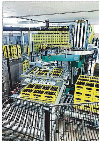
Durch eine Neukonstruktion ließ sich die Säulenhöhe soweit absenken, dass 3,80 Meter ausreichend waren. Aber zur Decke hin ist weiterhin nicht viel Luft. Fotos: BMS-Maschinenfabrik
