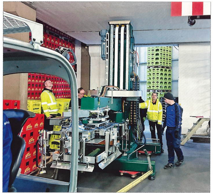
Geringere Säulenhöhe bedeutet gleichzeitig, dass der Palettierer stehend transportiert werden kann. Das reduziert den Transport-, Einbringungs- und Montageaufwand deutlich.
