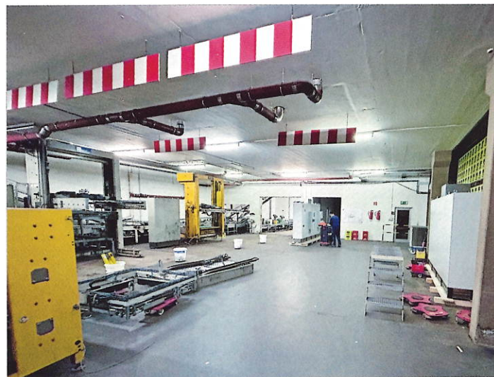
3,80 Meter Deckenhöhe, begrenzte Fläche, mehr Funktionalität – die Einplanung der neuen Palettierung der Brauerei Wittmann gestaltete sich als überaus anspruchsvoll. Fotos: BMS-Maschinenfabrik
